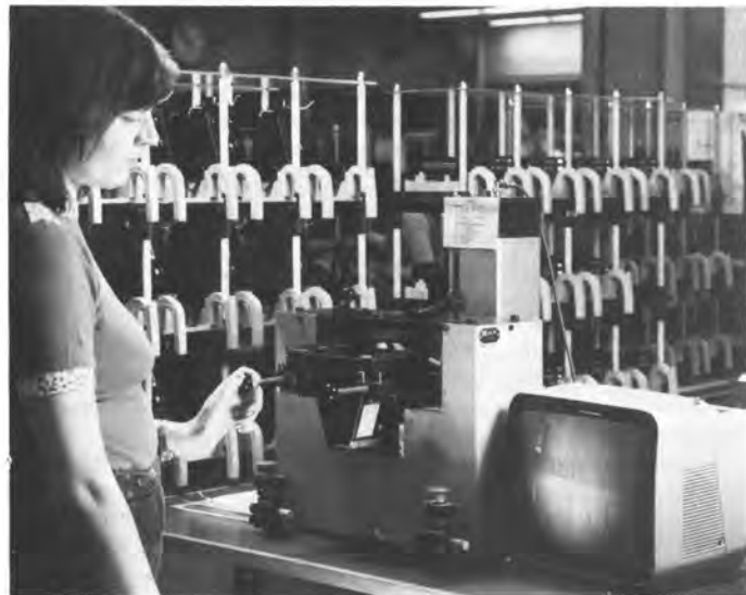
Hildegard Schulz examina en un monitor el plano de la película de una Cámara KODAK EK8 Instant con referencia a ejes ópticos.
